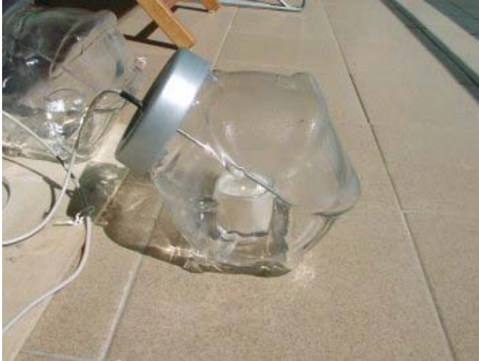
Fig. 3: Col·locació del vas amb llevat i glucosa i del sensor de temperatura dins del recipient de vidre
