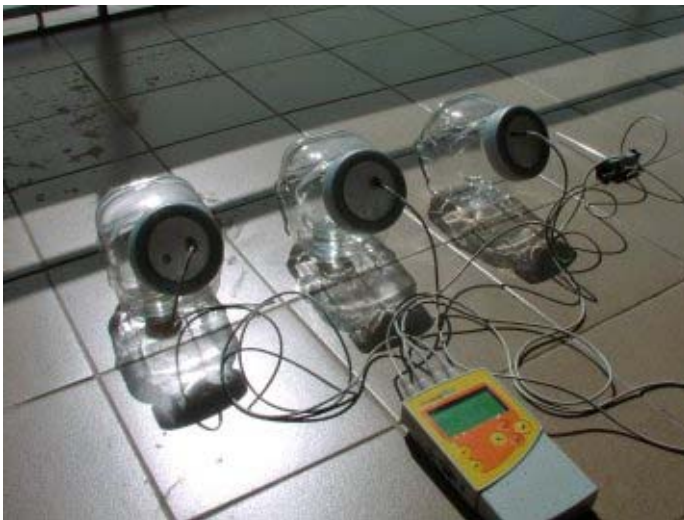
Fig.4: Vista dels 3 recipients de vidre, amb els vasos, i el sensors de temperatura
