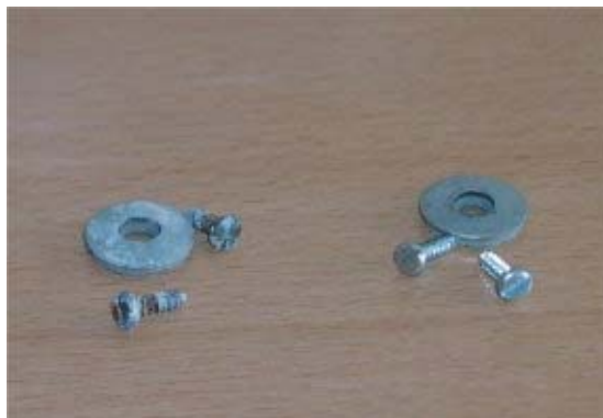
Fig. 4: Objectes metàl·lics que estaven a l'interior dels recipients. A la dreta en atmosfera control, a l'esquerra en atmosfera amb \text{SO}_2
