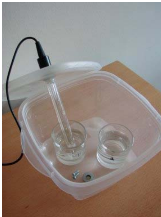
Fig. 2: Col·locació dels vasos, d'objectes metàl·lics i del sensor dins del recipient
