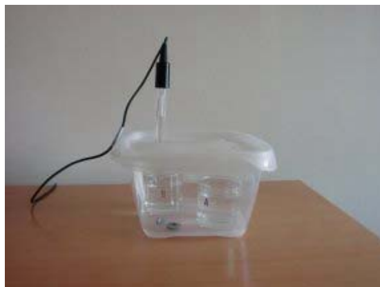
Fig. 3: Vista del recipient de plàstic amb els vasos, els objectes metàl·lics i el sensor de pH
