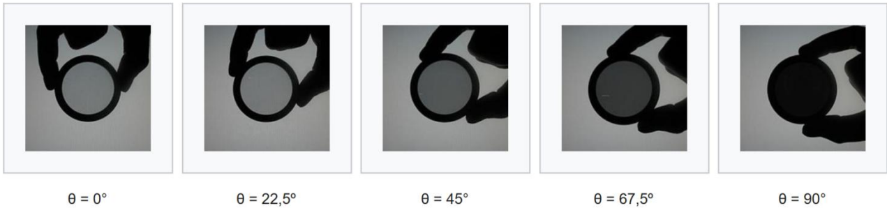
Diferentes ángulos del polarizador respecto de la dirección de la luz polarizada de entrada proveniente de una pantalla de ordenador, por por Ffred (CC, dominio público) via wikimedia commons
