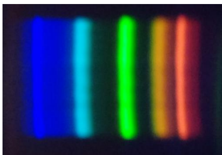
Espectro de una lámpara fluorescente obtenido con un espectroscopio de cartón de Public Lab
